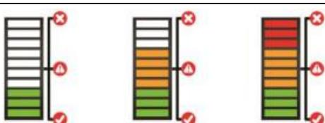
**CutSmart** – это новая функция от компании **Rotabroach**. Она предназначена для того, чтобы вы смогли получить максимум от своего станка. Данная функция реализована в виде визуального индикатора. Визуальный индикатор используется для отображения того, что сверлильный станок работает в соответствии с надлежащими техническими условиями.
